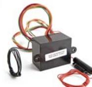
Реле предназначено для автоматического подъема транцевой плиты с целью избежания ее повреждения после выключения двигателя, при буксировке, транспортировке или стоянке катера. Устанавливается под приборной панелью. Подключается к блоку управления транцевой плиты и к замку зажигания двигателя. Рабочее напряжение – 12В. В комплект входят инструкция и крепеж. Производитель Bennett marine (США).
