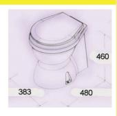
Унитаз судовой с электрической прокачкой. Отличается от 99902 исполнением корпуса, который закрывает основание, насос и установочные фитинги. Выходной штуцер снабжен невозвратным клапаном, предотвращающим выброс «черных» вод в унитаз из фекальной цистерны. Слив осуществляется за борт, либо в фекальную цистерну.
