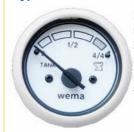
Индикатор уровня жидкости фекальных цистерн. Используется с датчиками **S3H** 240-30 Ом. Установочный диаметр 52 мм. Подсветка осуществляется желтым и красным цветом. Производитель Wemasystem(Норвегия).
