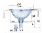
Раковина судовая с антигрязевым и антибактериальным покрытием. Поставляется в комплекте с металлическим патрубком диаметром 25.4 мм. Размеры - 316х339 мм. Производитель ТМС (Тайвань).
